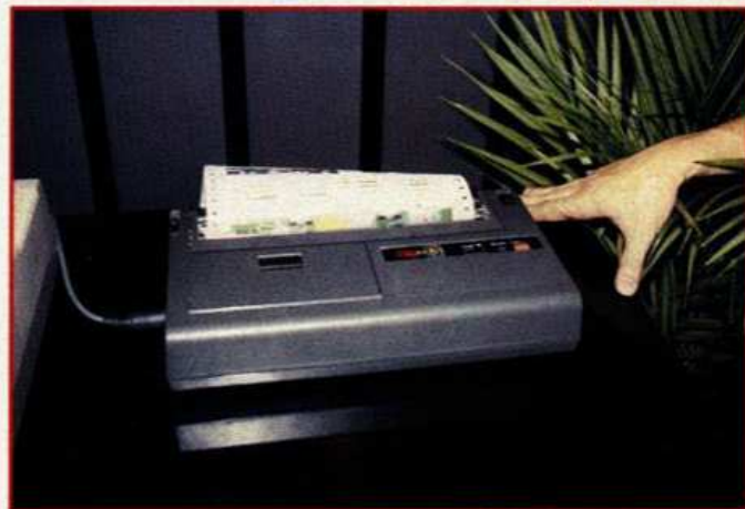
Preiswert aber langsam: »Okimate 10« arbeitet nach dem Thermotransfer-Prinzip und kostet komplett 238 Dollar
